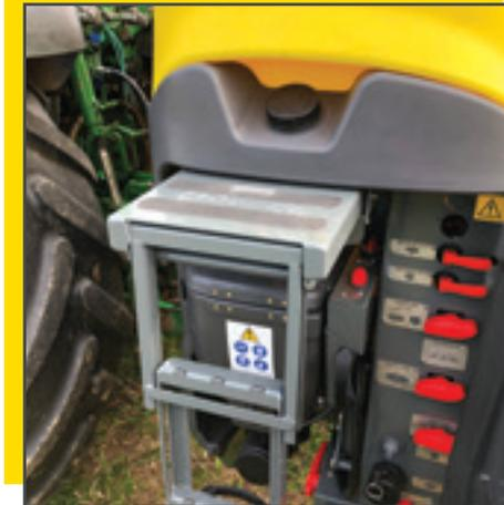
**Le tableau de mise en œuvre** : comme l'ensemble de nos machines, l'Hélium+ est doté d'un tableau de vannes très intuitif et ainsi facile de prise en main.
