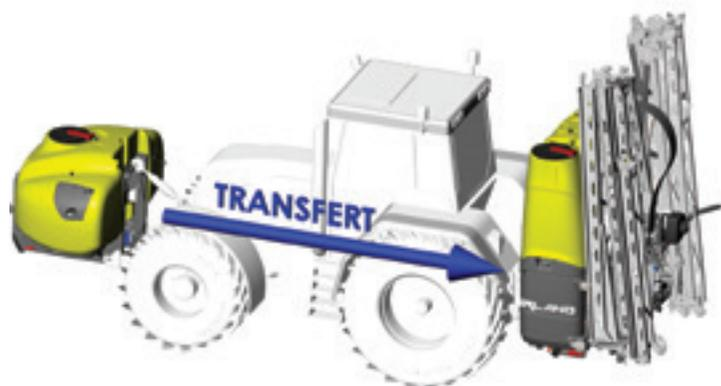
**Transfert** : Une pompe centrifuge de 500L/min située sur la cuve frontale permet le transfert avant-arrière de la bouillie. La cuve est équipée d'un rince bidon dans le trou d'homme et de gyrolaveurs à commande manuelle.
