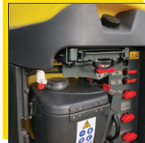
**L'incorporeur :** d'une capacité de 40L, l'incorporeur est monté sur parallélogramme
