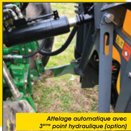
Attelage automatique avec 3<sup>ème</sup> point hydraulique (option)
