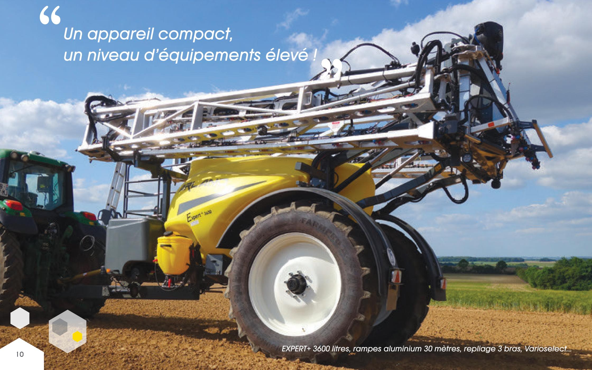
*EXPERT+ 3600 litres, rampes aluminium 30 mètres, repliage 3 bras, Varioselect...*
